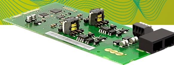
Extension de deux lignes principales analogiques avec commutateur fax intégré pour les systèmes IPBX de la famille COMpact
